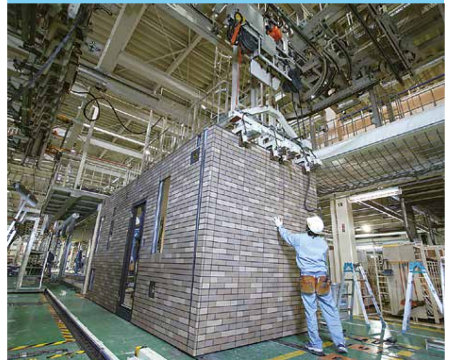
DE VERSCHILLENDE ONDERDELEN VAN EEN PREFAB-WONING WORDEN GEREED GEMAAKT IN DEZE SEKISUI PREFAB-FABRIEK.
